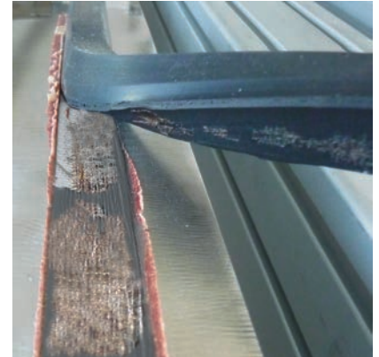
Heissverklebte Spurleisten anderer Hersteller können sich schon bei Temperaturen von 90° C vom Stahlband lösen.
